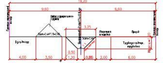
Схема строительной полосы ТИП 2 - 19,20 м (демонтаж судоход)
